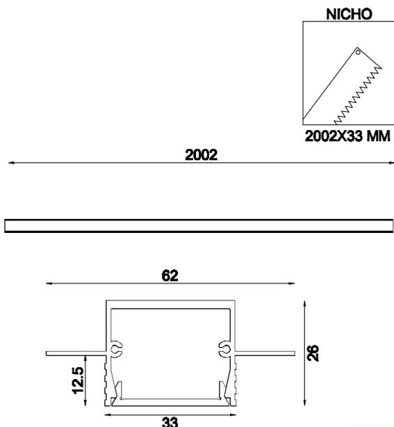
2 - Faça a instalação elétrica do driver e fita de led na luminária antes de chumbar no gesso. (obs.: prever local para alojamento e manutenção do driver, e retire o acrílico da luminária).
