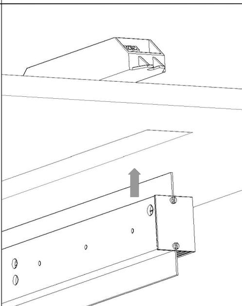
3 - Fixe os parafusos brocante em cada ponta da luminária, ( medidas abaixo para o parafuso ficar no centro da aba)
